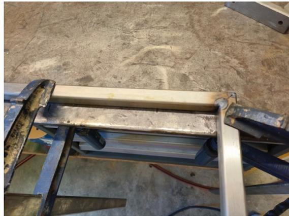
Abbildung 22: Schweißen des Gerüsts
