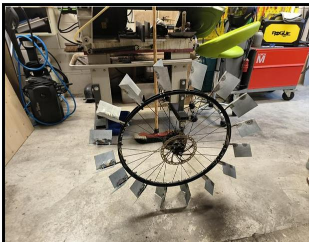
Die Schippen werden mit dem Rad per Schraubenmuttern verbunden.
