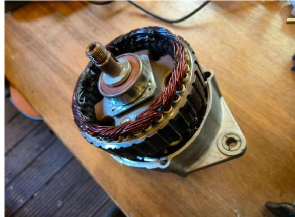
Abbildung 29: Lkw-Alternator (Elektromagneten)
