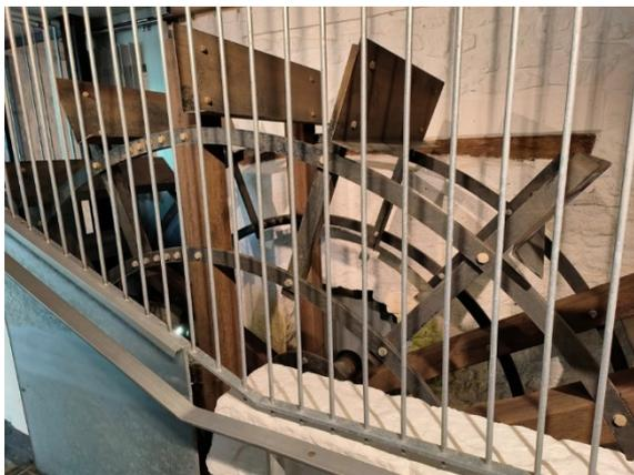
Der Wirkungsgrad des unterschlächtigen Wasserrad liegt bei ungefähr 35%.
