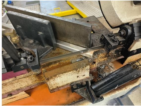
Abbildung 24: Sägen des Gerüsts
