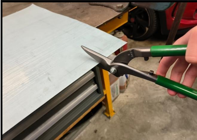
Mit einer Blechschere werden Rechtecke ausgeschnitten, welche späterhin die Schippen bilden.
