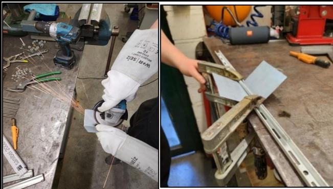
Die Schaufeln werden im richtigen Winkel per Schraubenzwingen gebogen und im Nachhinein mit einem Winkelschneider dort geschliffen, wo die Schweißung entstehen wird, um die Schutzschicht des Bleches zu entfernen, da diese sonst eine saubere Schweißung verhindern würde.
